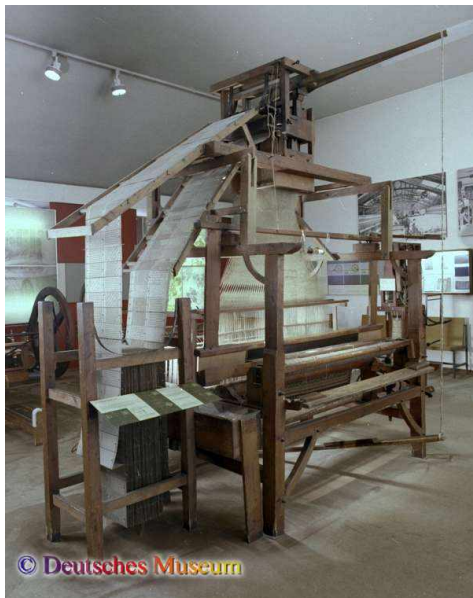
FIGURE 1.3 – Métier à tisser programmable.
