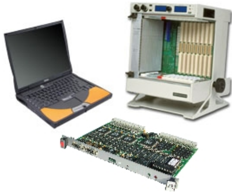
FIGURE 1.13 – Kit de développement sur Bus VME.
