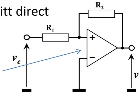
$$V_e \geq -\frac{R_1}{R_2} V_L = -k_d V_L$$
