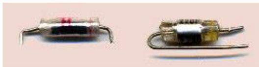
**MKS**, réalisée avec un isolant en polystyrène (polysulfone métallisé, styroflex, ...)
