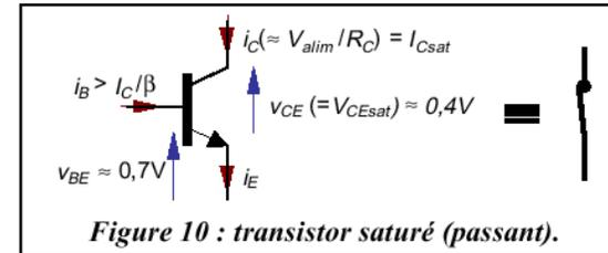
**Modèle équivalent en fonctionnement SATURÉ**
