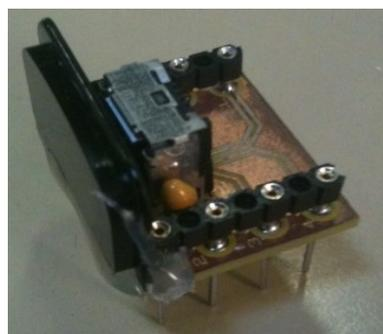
Nous avons fixé le filtre infrarouge sur le support afin de ne relever que les points infrarouges et ne pas être perturbé par d'autres sources lumineuses.
